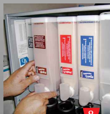
8 Introducir el contenedor en el engrane trasero, inclinándolo ligeramente y asegurarse de colocar la tapa.
