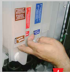
4 Retirar los contenedores levantándolos ligeramente y jalándolos hacia el frente.
