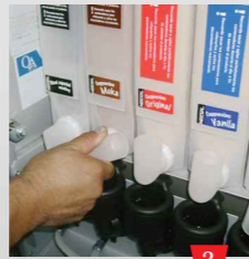
3 Girar las boquillas de producto.
